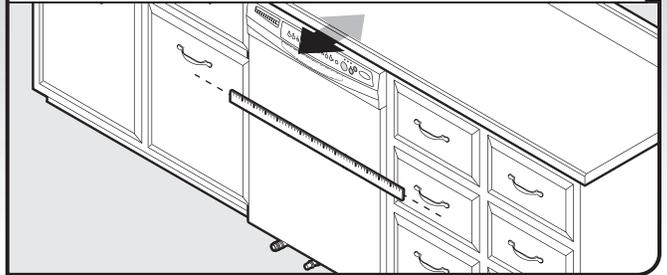
Aligner le panneau avant du lave-vaisselle avec la surface frontale des portes de placard; un ajustement peut être nécessaire.
